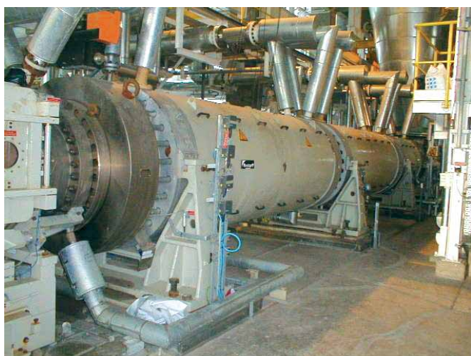
Figura 3: L'estrusore a coclea più grande del mondo
