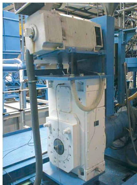
Figura 2: Configurazione azionamento dell'estrusore danneggiato
