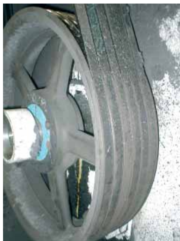
Figura 1: Azionamento a cinghie dell'estrusore dopo la rimozione dell'involucro
