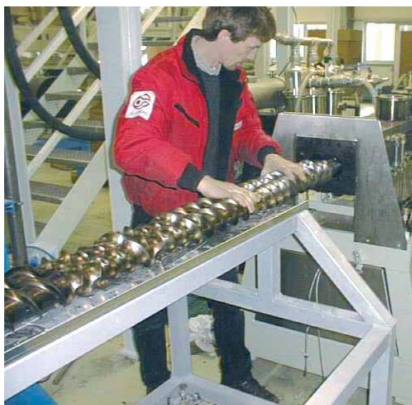
Figura 2: Installazione di nuove coclee
