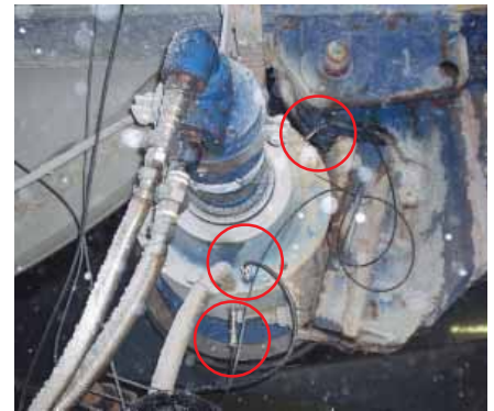
Figura 3: Accelerometri sul rullo di pressatura – installati in direzione verticale, orizzontale e assiale.
