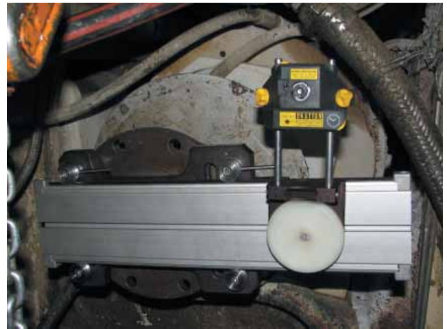
Figure 3: La staffa speciale per giunti cardanici permette di montare il laser e la ricevente con un
