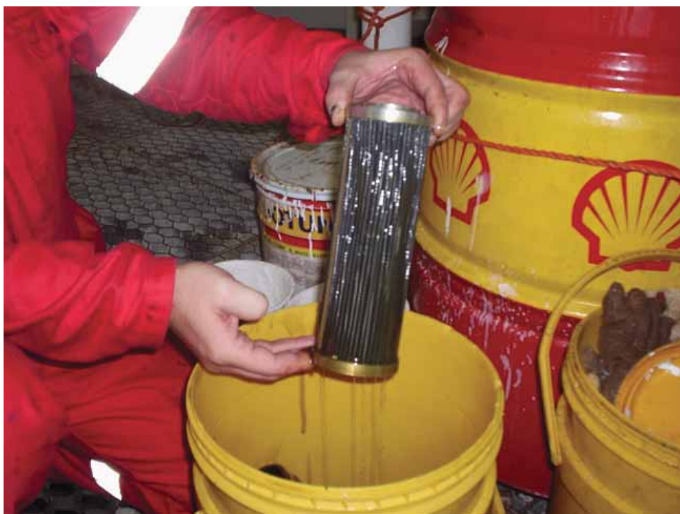
Fig.1: Analisi delle condizioni del filtro olio dopo la rimozione
