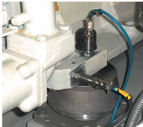
Fig.2: Accelerometri installati sulla base di un motore diesel
