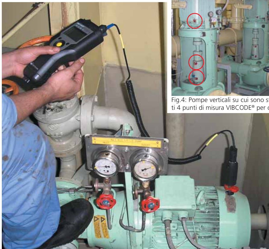
Fig.5: Misurazione del cuscinetto del motore lato ventola con VIBSCANNER®
