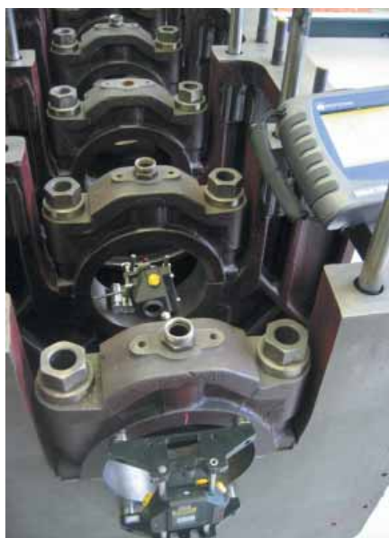
Fig.1: Strumentazione laser per il monitoraggio dei supporti dei cuscinetti
