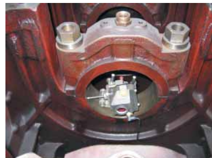
Fig.2: Il sensore laser, che può essere ruotato all'interno del foro
