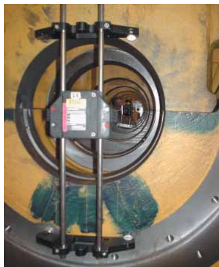
Fig.3: Trasmettitore laser con staffe magnetiche
